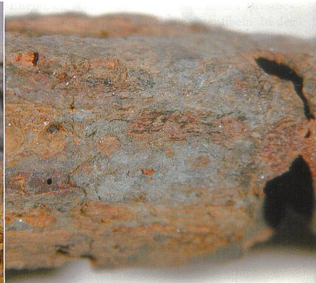
Landesmuseums zeigte jedoch, dass hier eine spezielle Form von Eisenkorrosion vorliegt, vermutlich Eisenphosphat, das während der Zersetzung des Leichnams entstehen kann.
