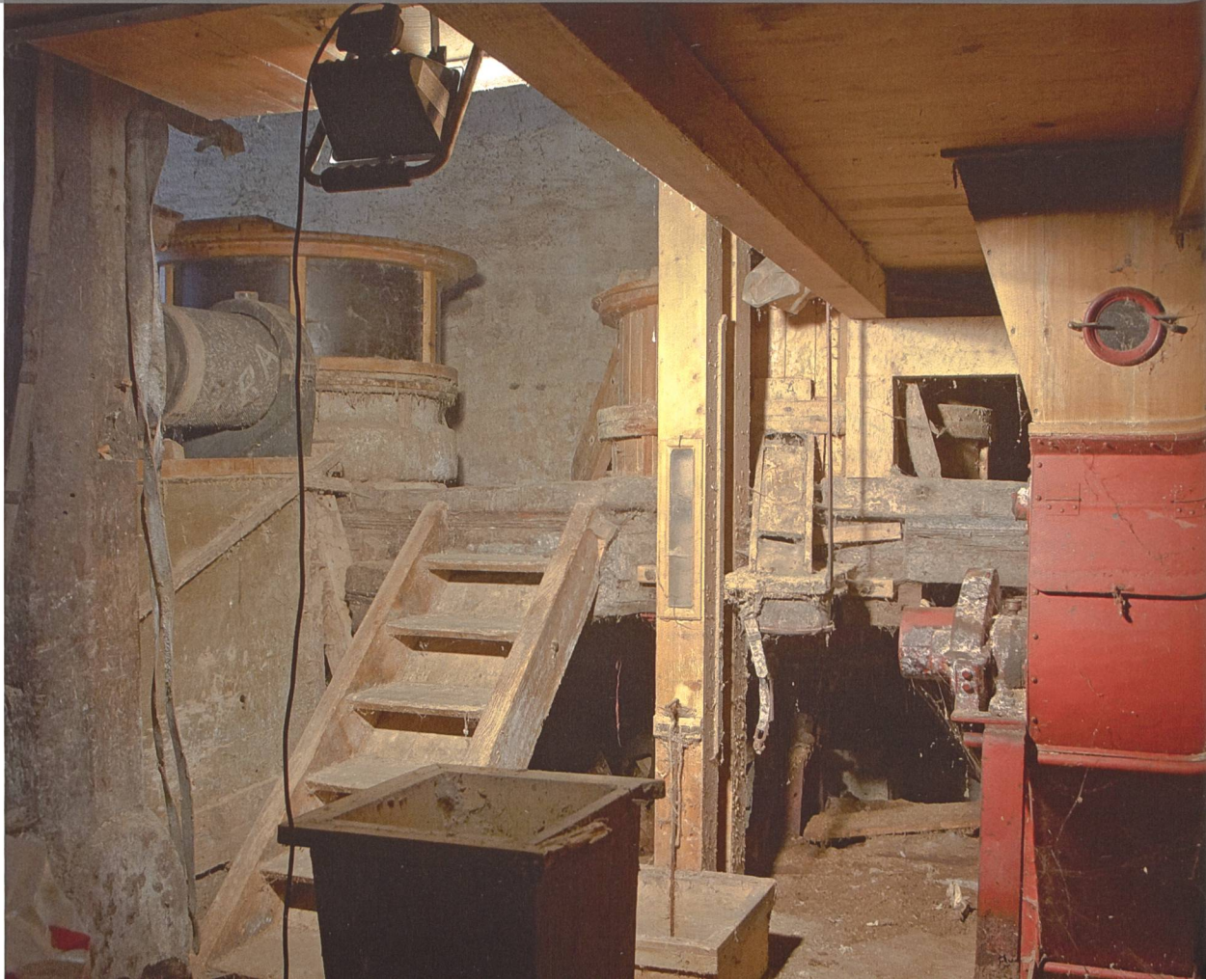
Zeglingen, Untere Mühle. Blick in den Mühleraum mit Mahltisch, Röllgang und Sichtertrichter.
