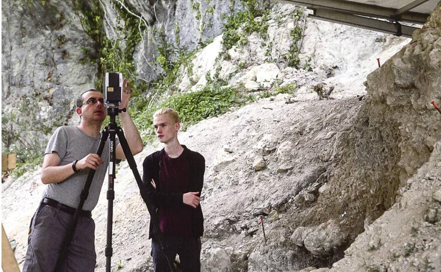
Grössere Objekte werden aus verschiedenen Positionen aufgenommen. Die Software «Faro Scene» erkennt Bereiche, die in mehr als einem Scan aufgenommen wurden, und kann so die Rohdaten von verschiedenen Aufnahmen zu einem einzigen grossen Bild zusammensetzen. So ist es beispielsweise möglich, alle im Zuge einer Bauuntersuchung erfassten Räume eines historischen Gebäudes in einer einzigen Punktwolke zu betrachten.
