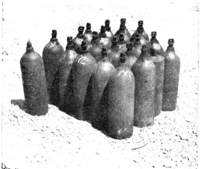
Die Standard-Eisenflaschen zum Transport von Quecksilber.
