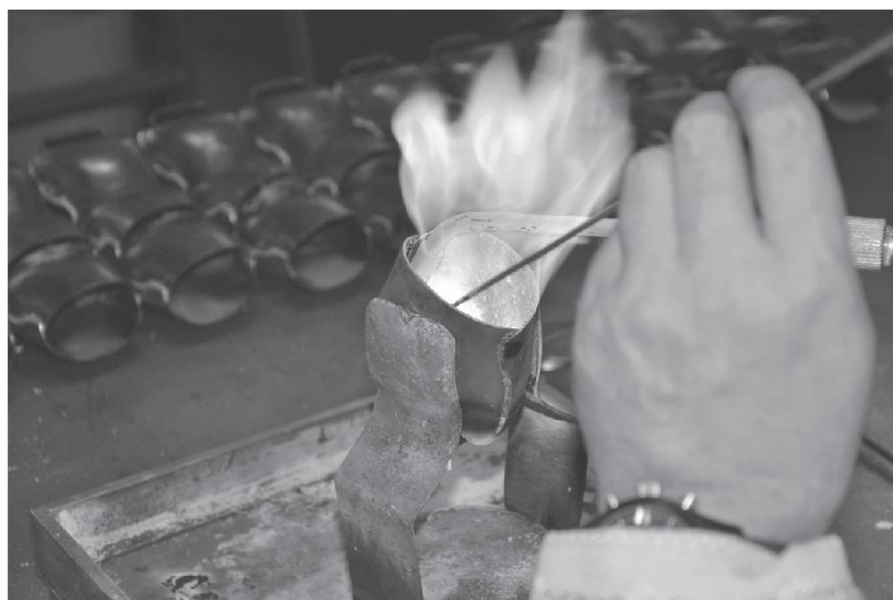
Fabrication d'une cloche en tôle repoussée. Démonstration à Bulle. Photo Bretz, 2013.
