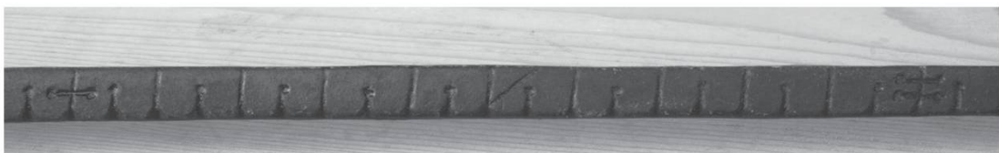
Détail du fléau de la balance - graduation en livres. Voir photo en page 4. Photo Anne-Marie Bimet, Savoie.
