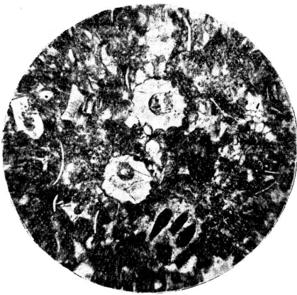
Fig. 1: Calcaire à tiges de Chara ( Clavator ). Coupe de la Dôle, niveau 35. \times 36 . » 2: Calcaire à Clypeina parvula Car. Coupe de Riondaz-Dessus, niveau 6. \times 60 . » 3: Calcaire à Munieria baconica Hauth. Coupe de Chez Villard, niveau 33. \times 60 . » 4: Calcaire à Actinoporella podolica Alth. Coupe de la Dôle, niveau 14. \times 36 . » 5: Calcaire dolomitique oolithique à Coprolithus salevensis Par. Coupe du Crêt-au-Bovairon, niveau 1. \times 60 . » 6: Calcaire à Acicularia elongata Car. Coupe de Chambrelieu, niveau 1. \times 60 .
