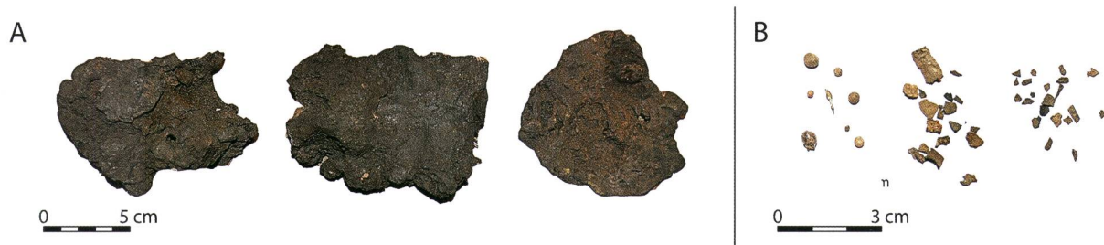
Fig. 10. Produits liés aux opérations d'épuration de l'éponge. A: Scories en forme de calottes plano-convexes. On remarque une grande homogénéité. B: Exemples de battitures sphériques (gauche), irrégulières (centre) et lamellaires (droite) récoltées dans les sédiments du crassier.
