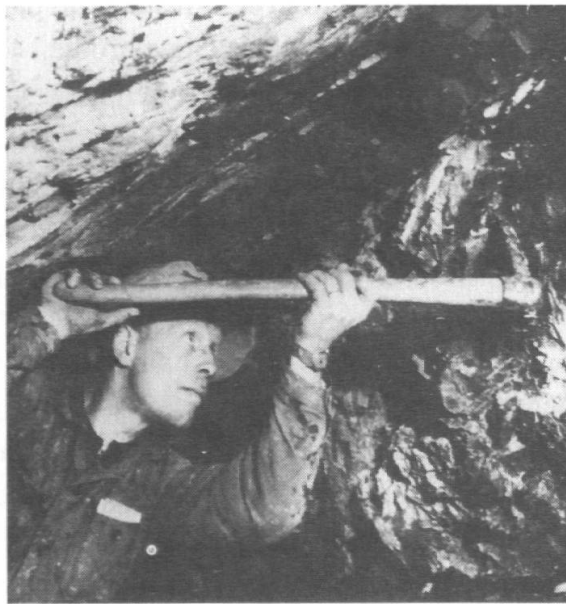
Le charbon est dégagé au pic pour ne pas l'émietter.
