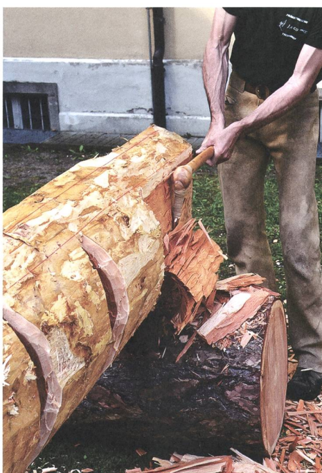
Abb. 86: Chur, Experiment, 26. April 2014. Förster und Zimmermann Jürg Hassler beilt die Schwarte in den Abschnitten zwischen den vorgängig geschlagenen Kerben ab.
