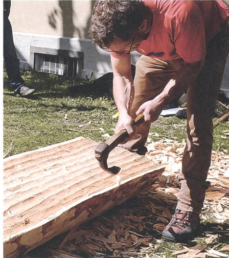
Abb. 90: Chur, Experiment, 26. April 2014. Mathias Seifert mit modernem Dechsel an einer Halbholzbreitseite.
