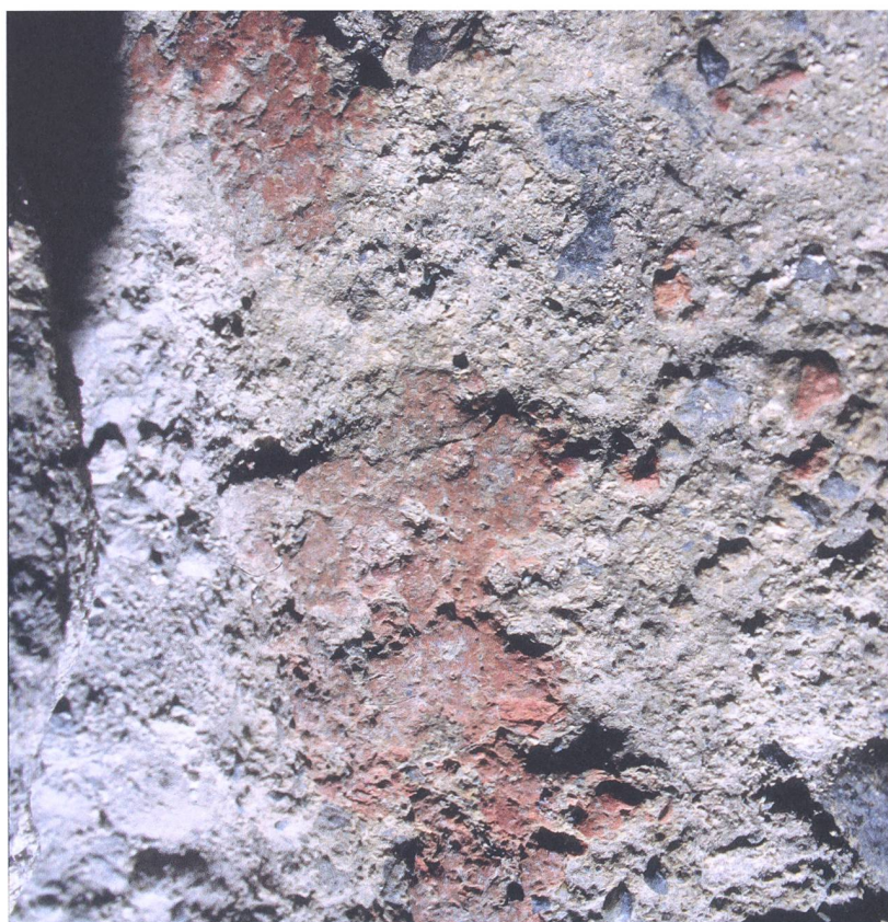
Abb. 149: Tomils, Sogn Murezi. Südannex E. Makroaufnahme von Mörtelboden (1030) mit Ziegelmehlschicht auf der Oberfläche.
