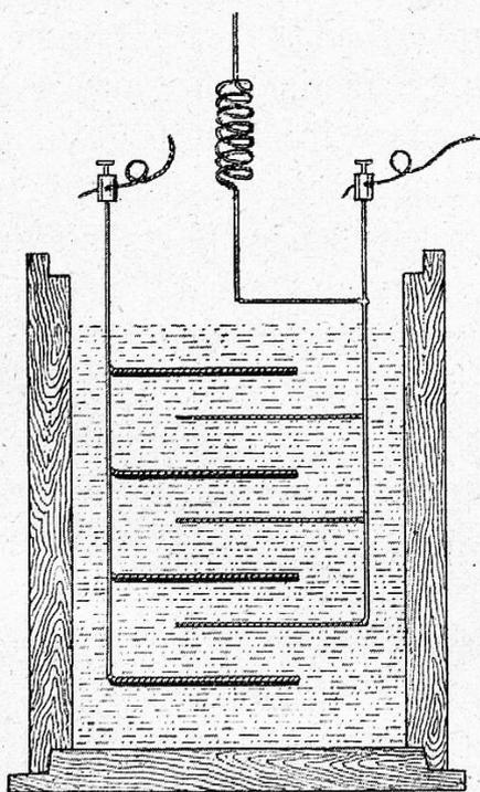
Kondensator für die gesammelte Luftelektrizität.
