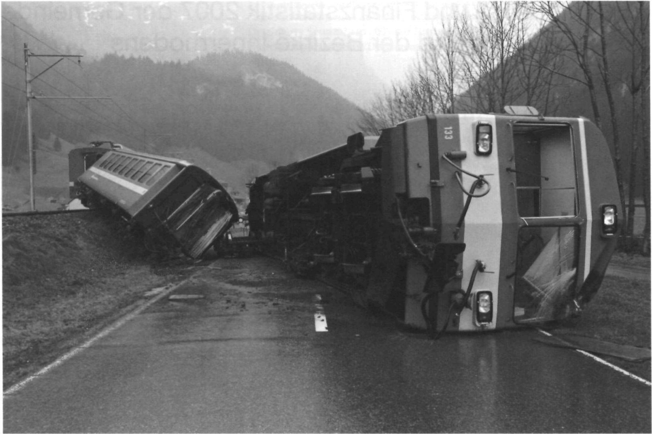
Durch den Laseyerwind verursachtes Bahnunglück beim Bahnhof Wasserauen.
