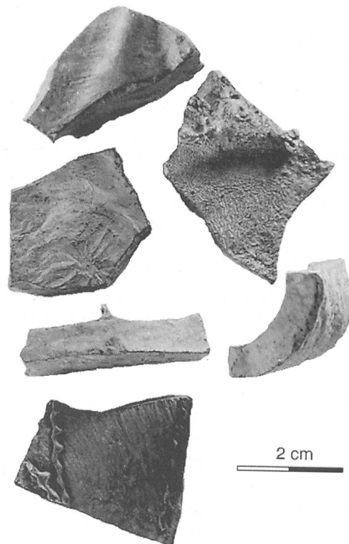
Abb. 2: Makroskopische Abbildungen von Fliessschlacken.
