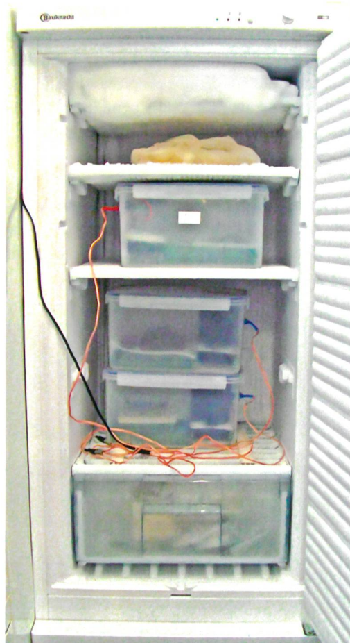
Fig. 2 : L'AFDbox, placée dans un congélateur, doit être sortie pour la pesée des objets en cours de séchage et le renouvellement du gel de silice.
