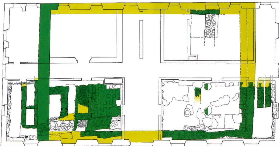
■ Mauerbestand Erdgeschoss Phase II; nachgewiesen (Umbau zu Seidenfärberei um 1780)
