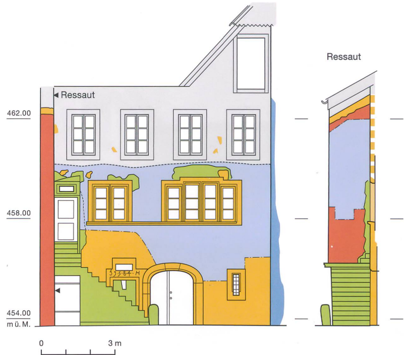
Fig. 2 : La Neuveville, Rue du Faubourg 21-25. Façade sud de la propriété rue du Faubourg 23 avec aperçu des phases d'aménagement. Ech. 1:150.
