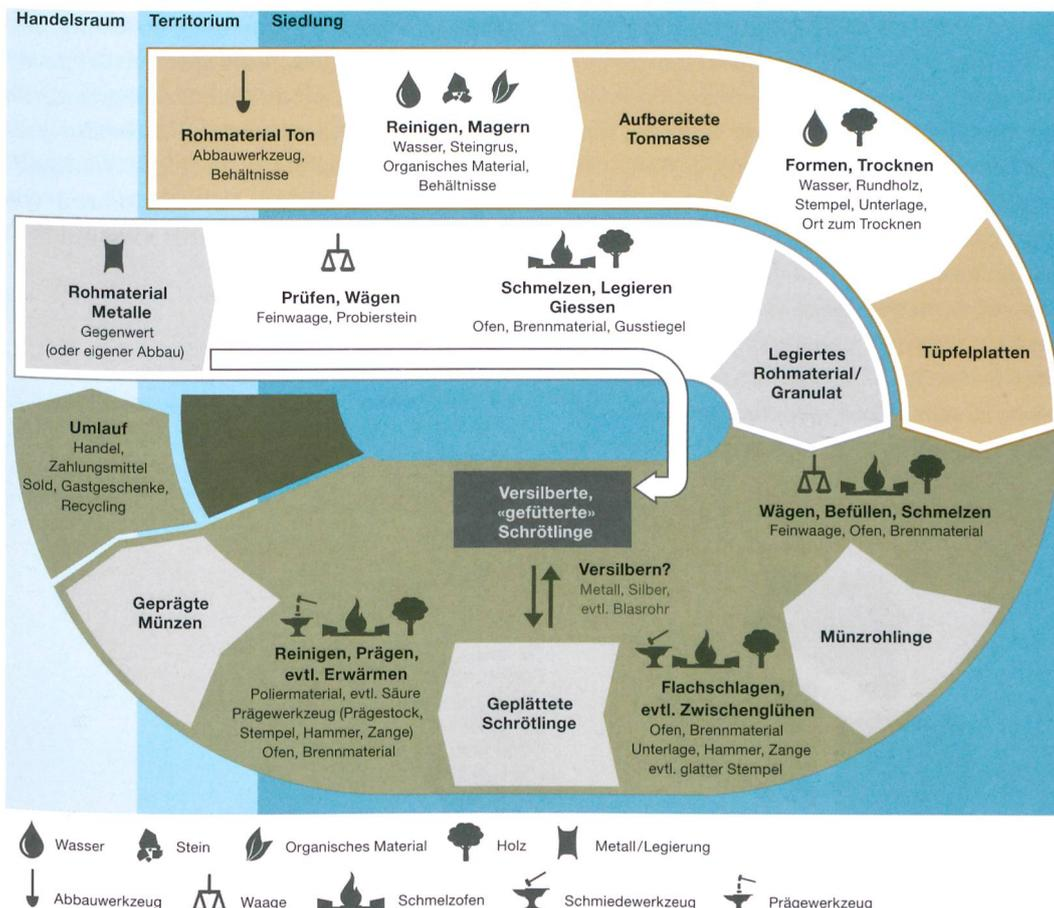
Abb. 21: Chaîne opératoire zur Herstellung spätlatènezeitlicher Silbermünzen.
