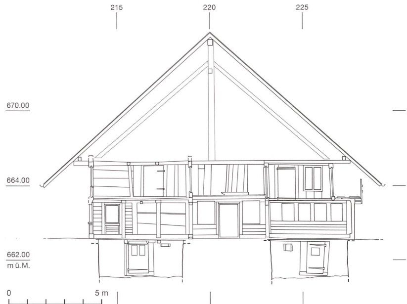
Abb. 2: Lützelflüh, Moosmatt 727a. Querschnitt. Im Schnitt ist deutlich zu sehen, dass Gaden- und Dachgeschoss schmaler sind als das Erd- und Kellergeschoss. Blick nach Südwesten. M. 1:200.
