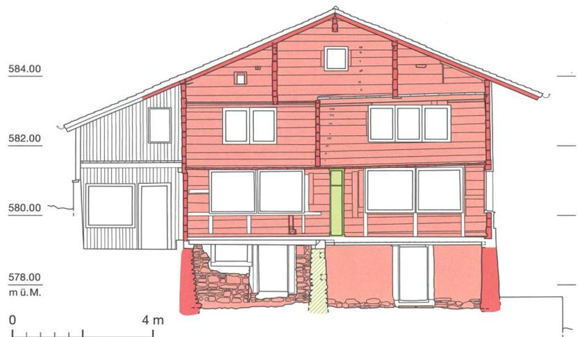
Abb. 6: Oberried, Untergasse 9. Der Obergaden liegt mittig über den ostseitigen Gaden und war wohl immer nur über eine Leiter zu erreichen. Süd- und nordseitig schliessen sich kleine offene Kniestöcke an. Die beiden grossen Unterzüge im Vordergrund des Bildes bestehen aus sekundär verbautem Bauholz und sind deutlich jünger (1679d). Sie wurden bei der Aufgabe der offenen Rauchküche eingezogen. Blick nach Nordosten.
