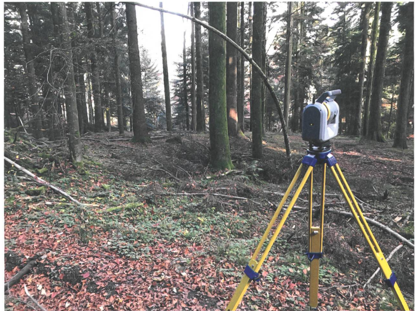
Abb 7: Trachselwald, Chammenegg. Vermessung des Geländes mithilfe der Totalstation und des Laserscanners mit Unterstützung des Globalen Navigationssatellitensystems (GNSS).
