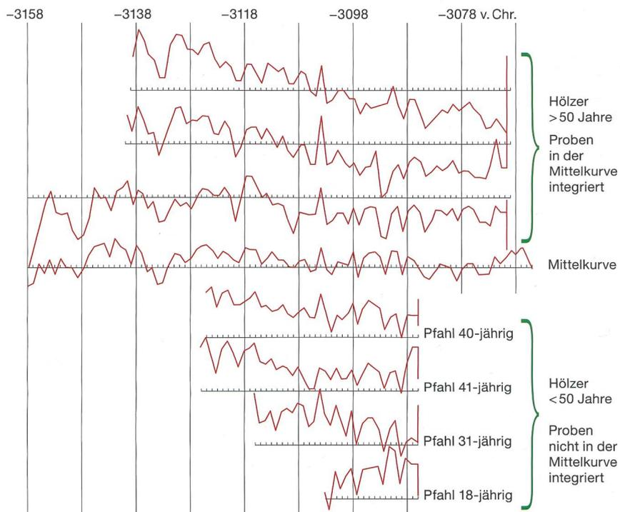
Abb. 16: Schema zur Synchronisierung von Jahrringkurven. Zunächst wird pro Fundstelle aus den Hölzern mit über 50 Jahrringen eine Referenzmittelkurve erstellt. Anschliessend werden Proben mit weniger Jahrringen untereinander gruppiert und synchronisiert und dann anhand der vorher erstellten Mittelkurve datiert, ohne dass diese kürzeren Jahrringkurven jedoch in die Mittelkurve integriert werden.
