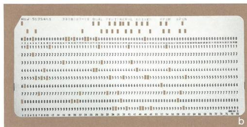
Abb. 7: Für die ersten dendrochronologischen Untersuchungen der Hölzer von Twann wurden die Messungen der Jahrringbreiten der Hölzer auf Lochstreifen (7a) erfasst, auf Lochkarten (7b) übertragen und von einem Techniker in den Hauptcomputer der Universität Köln eingespielen.
