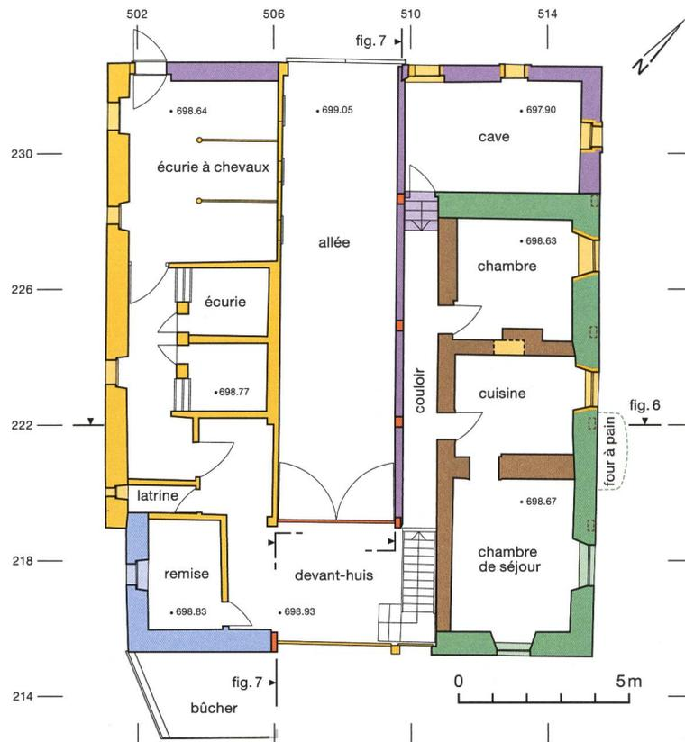
Fig. 5 : Valbirse, Bévillard, Les Vannes 15. Plan de masse du rez-de-chaussée. Éch. 1:200
