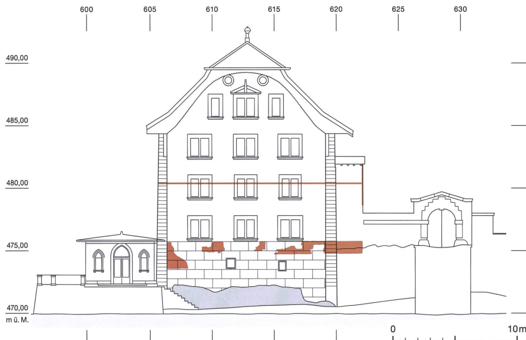
3 Utzenstorf, Schloss Landshut. Ostfassade. Rot: Mauerwerk der Phase 2 (s. Abb. 3) mit horizontal verlaufendem Absatz auf Höhe des ersten Obergeschosses. Blick nach Westen. M. 1:300.
