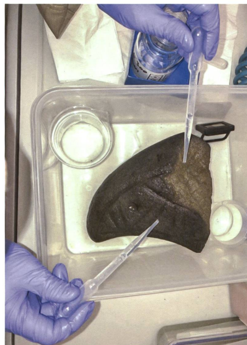
5 Burgdorf, Schloss. Consolidation du croissant à la pipette jusqu'à refus avec un silicate d'éthyle (KSE 300 de Remmers).
