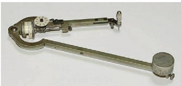
Abb. 22: Amsler Polarplanimeter zur Flächenmessung auf Plänen
