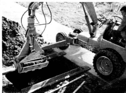
Der neue selbstfahrende Hydraulik-Schmalspur-Bagger für enge Friedhofwege, der rationell, arbeitskräftesparend und schnell Grabstätten aushebt. Eignet sich auch vorzüglich für die Durchführung anderer Grabarbeiten. Ist kipp- und standfest und ausserdem sehr preiswert.
