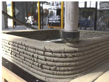
*Bewährung am Objekt:* Eines dieser Objekte entstand zusammen mit der Frutiger AG im Auftrag von Swisscom. Die Druckdaten wurden nach den Plänen des Bauherrn aufbereitet. Mittels 3-D-Druck-Verfahren erstellte Creabeton Matériaux innerhalb von nur 45 Minuten einen massgeschneiderten Schacht.
