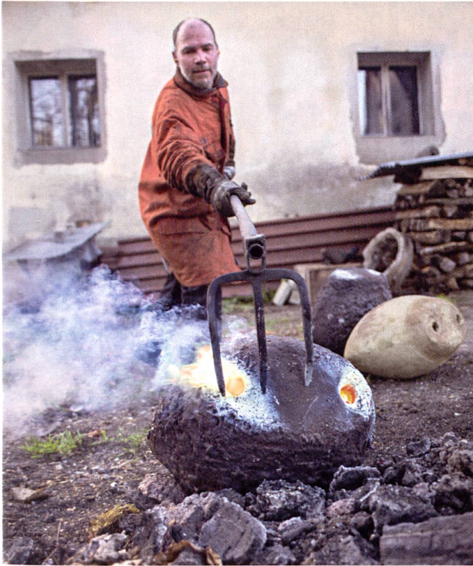
Peter Preisig legt die glühende Lehmpackung zum Auskühlen auf den Boden.
