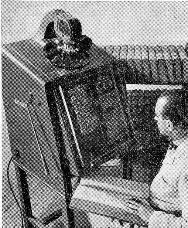
Beste Lesbarkeit aller Filme, in Rollen oder Streifen. Veränderliche Vergrößerung von 12- bis 23fach. Große Mattscheibe aus blendungsfreiem Spezialglas, grün. Zentriervorrichtung, 2 Übersetzungen.
