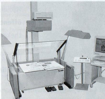
Bedienungsmodi: Nur Scannen, nur Verfilmen oder gleichzeitig Scannen **und** Verfilmen. Die automatische Hybrid-Funktion erfasst in nur sieben Sekunden eine Vorlage archivssicher! Flexible Buchwippen sichern den schonenden Umgang mit dem Original.
