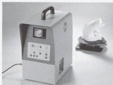
Lo scanner 3D portatile della Minolta permette di leggere 40'000 punti in meno di un secondo ed è utilizzabile anche in abbinamento ad un tavolo rotante automatico.
