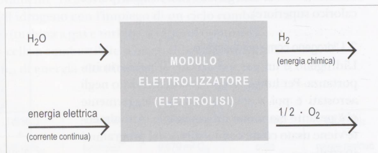
4 - La rappresentazione schematica di un elettrolizzatore
