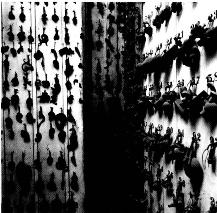
Beispiel einer für den Gebrauch sauber geordneten Nische im Gussmodellager. Bei den Teilen handelt es sich zumeist um so genannte Abschlussknöpfe oder Ausläufer, wie sie beispielsweise an Kronleuchtern zur Anwendung kamen. (Foto: Stephanie Tremp, Basel)
