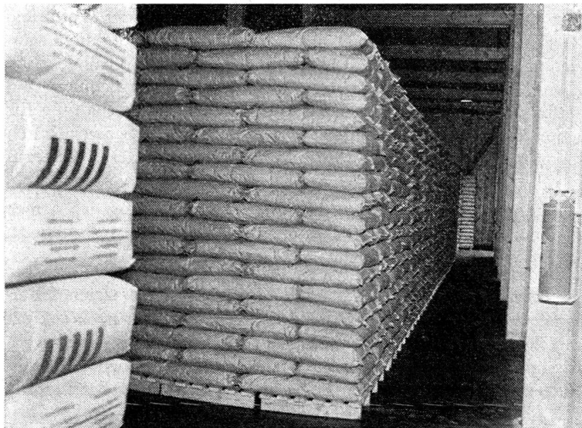
Ware mit wenig Lager- bewegung wird aus Platz- gründen mehrere Schichten hoch nicht auf Paletten, sondern auf Rosten gelagert.
