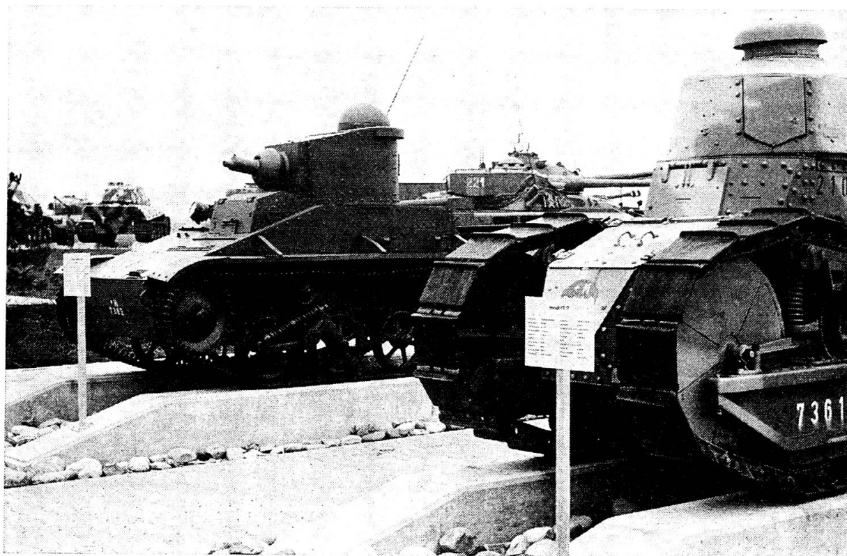
Alttester Panzer im Panzermuseum in Thun: Renault FT 17 (2 Mann Besatzung, 40 PS, 8 km/h, Schweiz)
