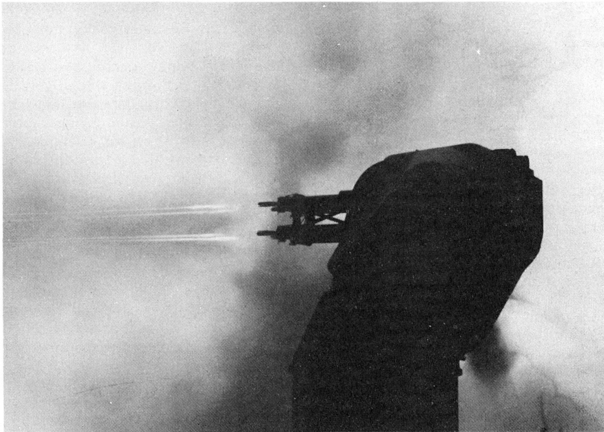
Automatisches Oerlikon 25-mm-Vierlingsgeschütz mit einer Gesamtschussfolge (zyklisch) von 3400/Min
