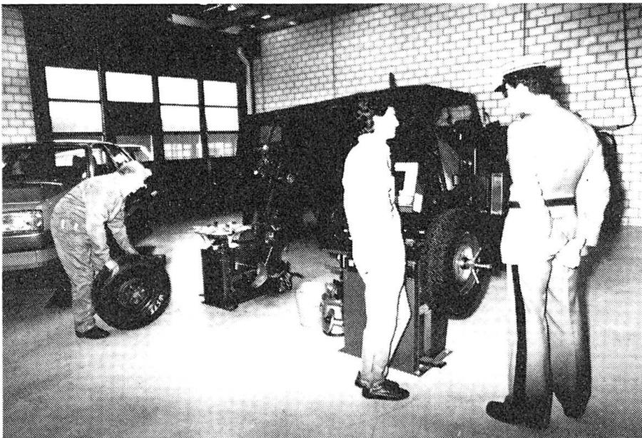
Ein eigenes Pneulager sowie modernste Maschinen stehen für die Pneumontage zur Verfügung.
