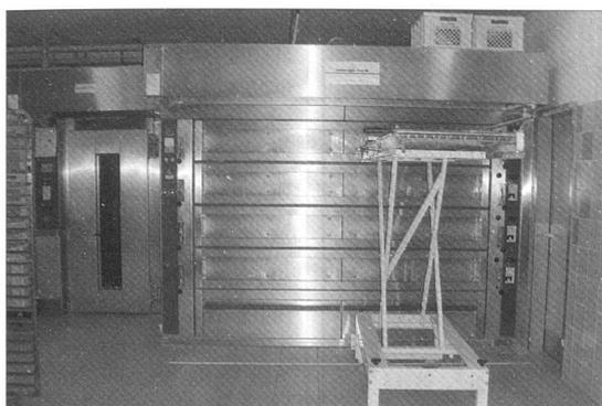
Fours électriques à étage et rotatif à air pulsé.
