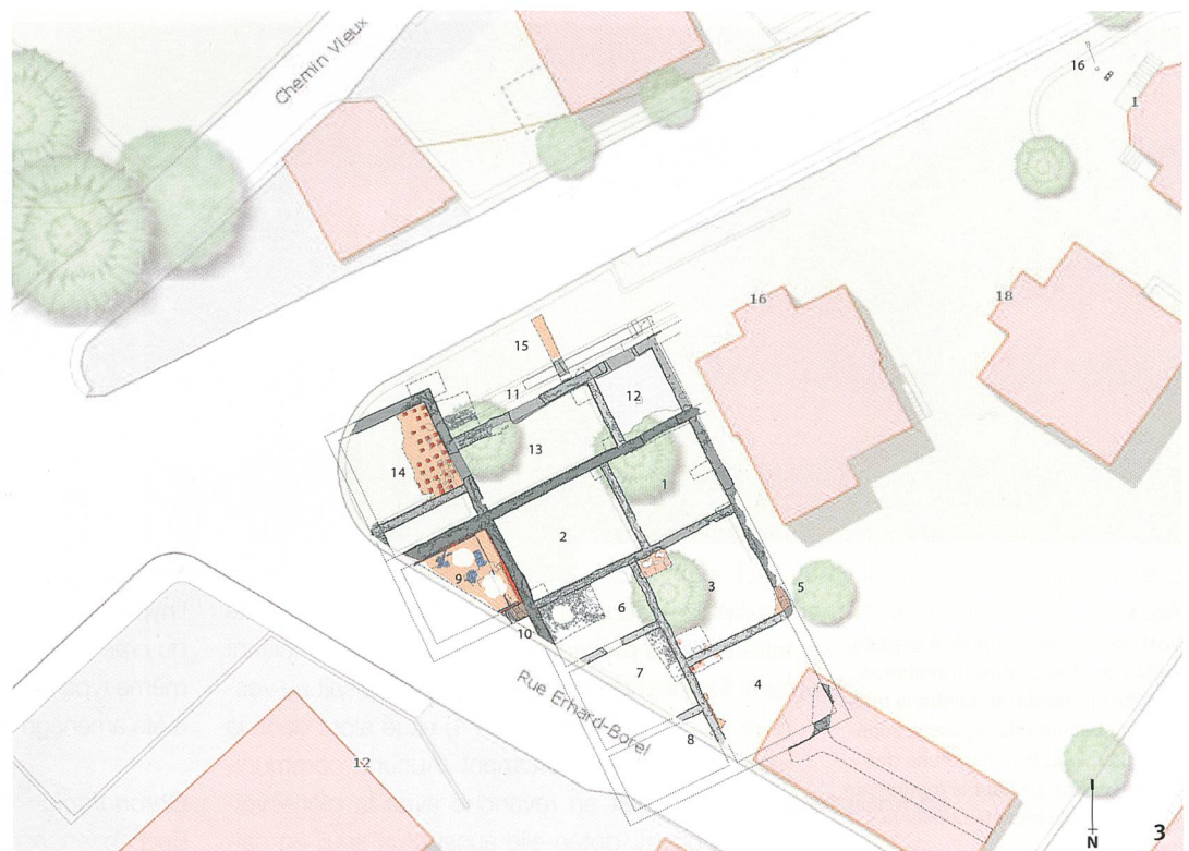
Fig. 3 Plan des bains romains de Serrières. ETAT 1: 1 et 2 salles froides ( apodyterium et frigidarium ), 3 et 4 salles chaudes ( laconicum et caldarium ), 5 praefurnium , 6 et 7 salles froides à dalle maçonnée épaisse, 8 indéterminé, 9 salle chaude voûtée ( sudatorium ?) transformée ensuite en bassin, 10 praefurnium . ETAT 2: 11 égout, 12 vestibule, 13 grande salle froide, 14 salle chaude à bassin, 15 cour. MEDIEVAL: 16 tombe du 8 e siècle.
