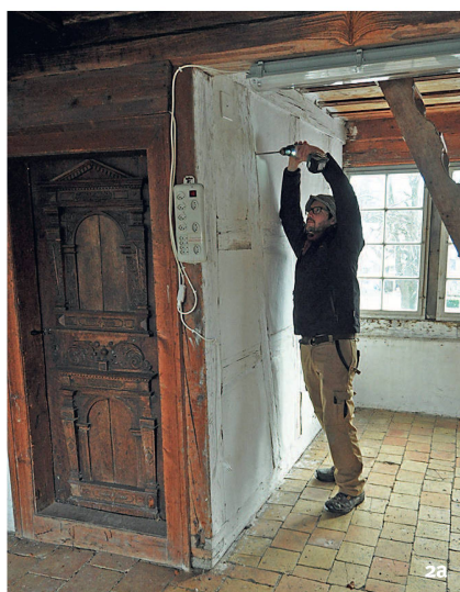
Abb. 2 Probenentnahme und dendrochronologische Auswertung im Labor.
