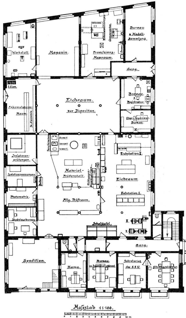
Abbildung 2. Räumlichkeiten der technischen Prüfanstalten im Erdgeschoss.
