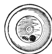
Abbildung 6 Ansicht eines Stöpselkopfes Patrone unversehrt Patrone durchgebrannt
