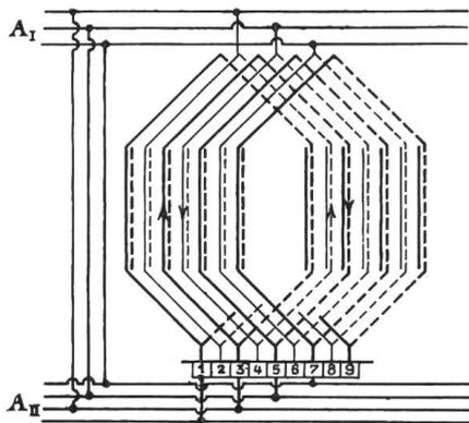
Abbildung 5. Zweifache Schleifenwicklung, bzw. zweifache Parallelschaltung:  $2a = 4p$ .
