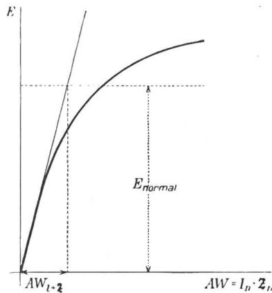
Abbildung 2. Bestimmung von  $AW_{I+z}$  aus der Leerlaufscharakteristik.
