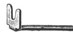
Abb. 32. Rahmenhalter, dessen gabelförmiger Teil an der Hohlchiene zwischen Gleitmutter und Sockel befestigt wird.
