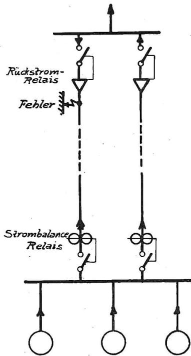
Fig. 21. Schematische Anordnung des Schutzes von Parallel-Leitern mit Rückstrom- und Stromvergleichs-Relais.
