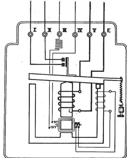
Fig. 16. Schematische Darstellung des Rückstrom-Relais der Masch.-Fabrik Oerlikon.
