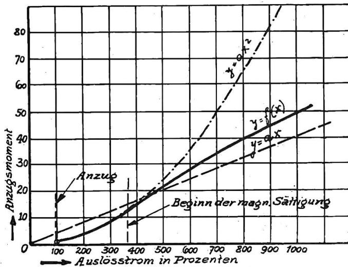
Fig. 5. Kurve des Anzugsmomentes von Relaismotoren.
