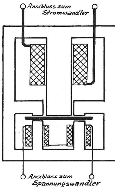
Fig. 13. Schematische Darstellung eines Rückstrom-Relais mit Induktionswattmeter-Messgerät.
