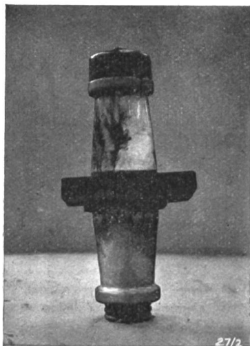
Fig. 4. Ueberschlag am Isolator durch Russniederschlag, vom Schaltergas erzeugt. Durchführungsisolator (3000 V Betr.-Spng.) Ueberschlagsspannung in Luft 32 kV rein Ueberschlagsspannung in Luft 19 kV, nachdem der Isolator unter Spannung in Schaltergas gewesen (30 Abschaltungen zu 20 kW).
