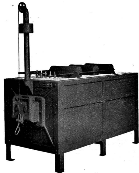
Fig. 2. Grosser Glühofen. Regulierung mittels Induktionsregler; wird in zwei Typen von 28 und 43 kW Anschlusswert hergestellt.
