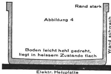
Dieses Geschirr wird aus einem Stück durch Pressen hergestellt. Die Fig. 1 bis 4 zeigen es im Schnitt. Der Boden wird leicht hohl gedreht (0,3 bis 0,5 mm), womit erreicht wird, dass er in kochwarmem Zustande auf der Kochplatte plan aufliegt, während ein in kaltem Zustande ebener Boden sich bei Erwärmung nach aussen
