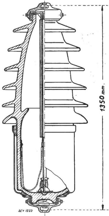
Fig. 1. Porzellankondensator.
